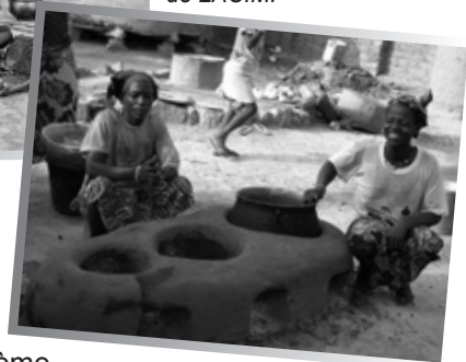
A gauche : foyers sommaires habituellement utilisés. Ci-dessous : les foyers améliorés construits avec l'aide de LACIM.
